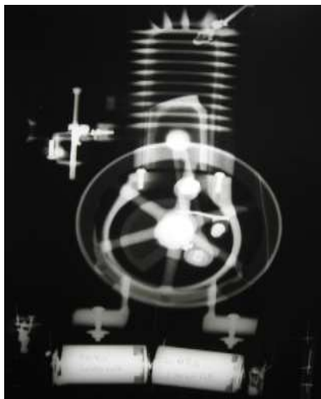
Figura 3 - Imagem do protótipo obtida através do uso de tensão no tubo de 50 kVp, corrente de 200 mA, tempo de exposição de 0,05 s e adição de filtro de Al com espessura de 1,0 mm.
