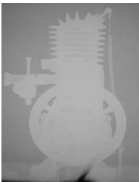
Figura 5 - Imagem do protótipo obtida através do uso de tensão no tubo de 70 kVp, corrente de 200 mA, tempo de exposição de 0,8 s e sem adição de filtro.
