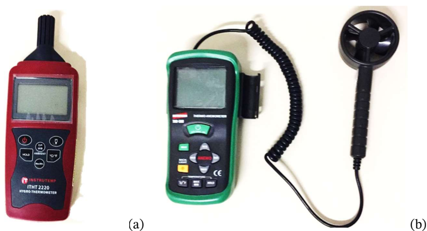
Figura 3: Instrumentos de medição utilizados, (a) psicrômetro digital e (b) anemômetro digital.
